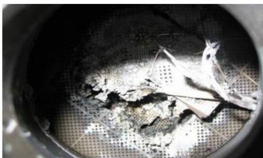
Filteri ispušnih čestica koji imaju mehaničko oštećenje nastalo pregaranjem, moraju se zamijeniti
