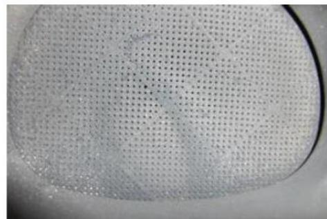
Ukoliko je Filter ispušnih čestica zaprljan kao na slici, može se očistiti TUNAP sustavom za čišćenje
