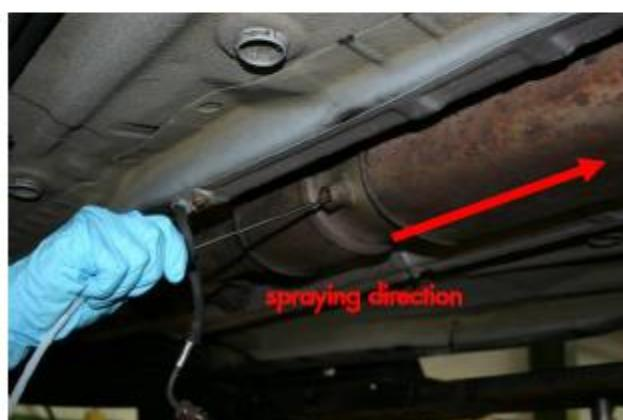
1. Odvojite senzor temperature ili sondu diferencijalnog tlaka sa filtera ispušnih čestica.
